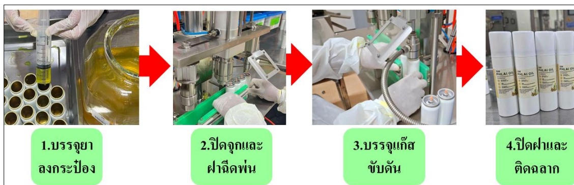
ภาพที่ 5 กระบวนการผลิตสเปรย์ไพลแอโรซอล
