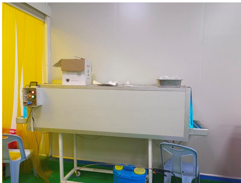
ภาพที่ 8 อุปกรณ์ฆ่าเชื้อด้วยรังสี UVC ผลิตภัณฑ์สับปะรดตัดแต่งพร้อมบริโภค
