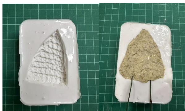
ภาพที่ 21 การสร้างต้นแบบแม่พิมพ์แบบกลีบประดับ (ภาพโดย : รักชนก อินจันทร์)
