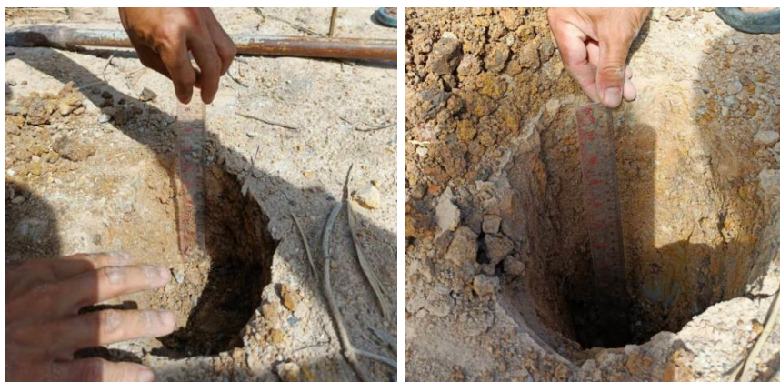
ภาพที่ 15 การสุ่มตัวอย่างดิน จากระดับความลึก 6 นิ้ว และ 12 นิ้ว
