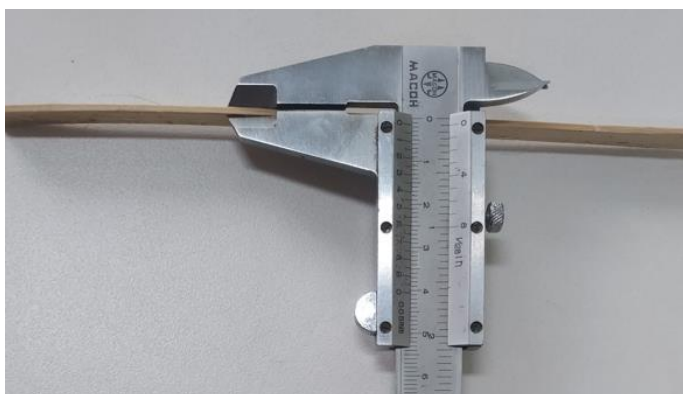
ภาพที่ 3.14 การวัดตรวจสอบความหนาของตอก
