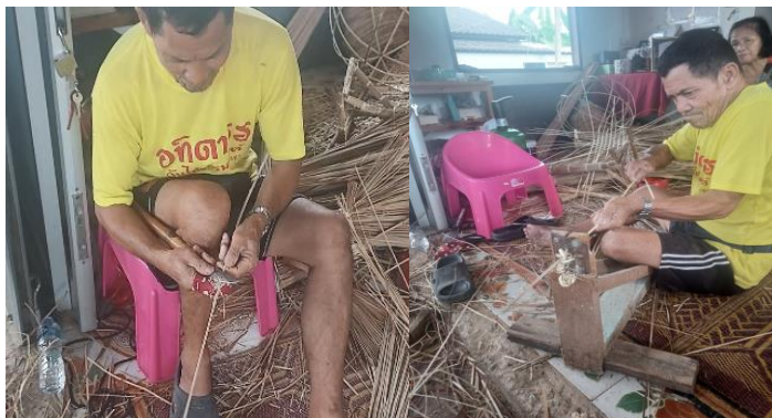
ภาพที่ 1.8 การเหลาตอกด้วยแรงงานคน
