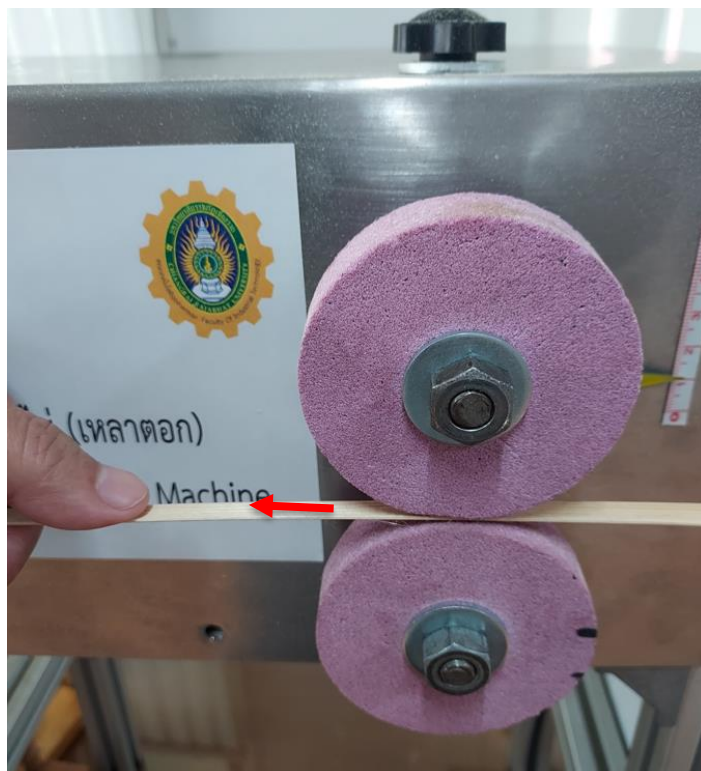
ภาพที่ 3.16 การดึงเส้นตอกออกจากหินขัด
