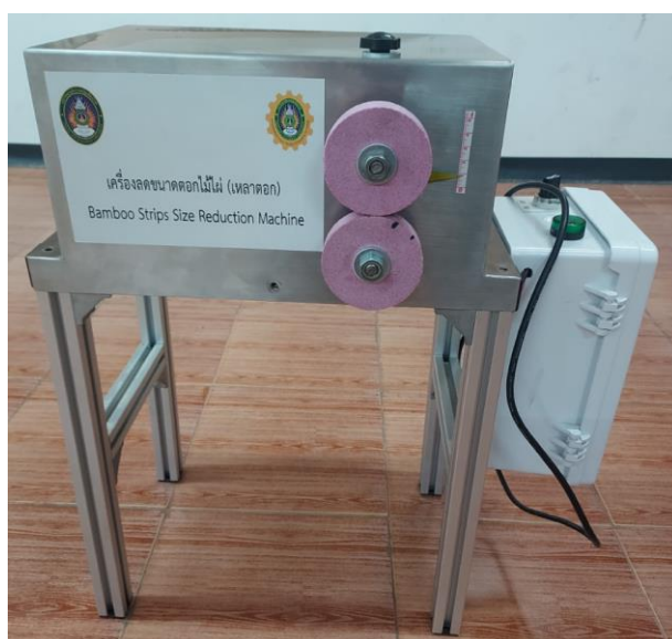
ภาพที่ 3.9 เครื่องลดขนาดตอกไม้ไผ่ที่เสร็จสมบูรณ์
